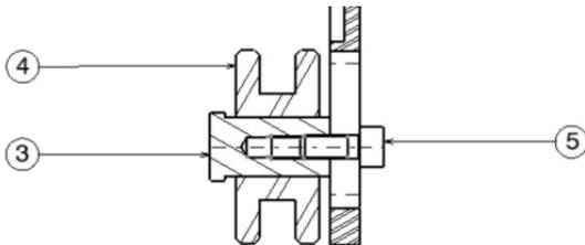
Le maintien en position de l'axe (3) du galet (4) sur le support est réalisé par une vis à 6 pans creux (5) ; il est nécessaire de maintenir l'axe de galet pour qu'il ne tourne pas pendant l'opération de serrage.
