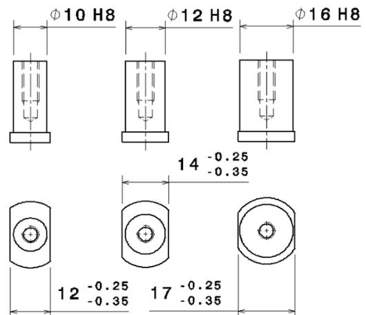
En fonction du type de vélo on prévoit trois dimensions de l'ensemble anti-déraillement : il est donc nécessaire d'étudier et de produire trois types d'axes. Seules les dimensions ci-contre sont modifiées.
