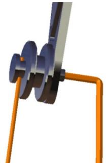
Pour permettre au mécanicien d'empêcher l'axe du galet de tourner pendant le serrage, on a choisi d'utiliser une tige de Ø 3. Le concepteur a donc prévu un perçage de Ø 3 qui permet de positionner la tige.
