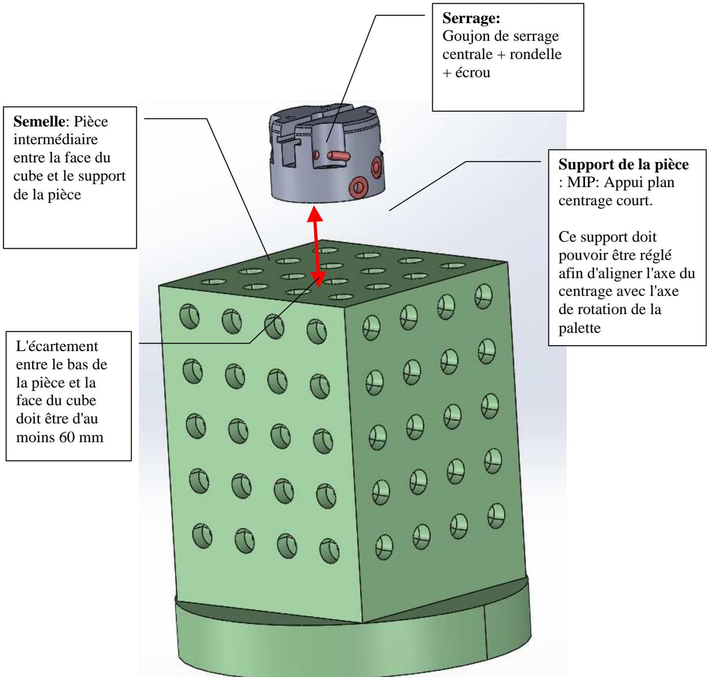
**Partie 2:** Réaliser dans SOLIDCAM l'usinage de cette phase 50 avec l'environnement d'usinage précédent
