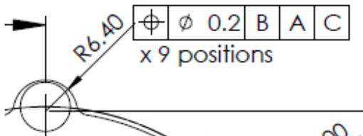
Les bossages sont positionnés par rapport aux surfaces B, A et C
