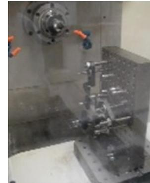
**Problème:** Dans le repère machine ( $O_m, Z, X$ ), il s'agit de déterminer les coordonnées d'un point  $OP2(z_2, x_2)$  qui est le résultat de la rotation d'un angle  $\alpha$  d'un point  $OP1(z_1, x_1)$  autour du centre de la palette ( $C$ )
