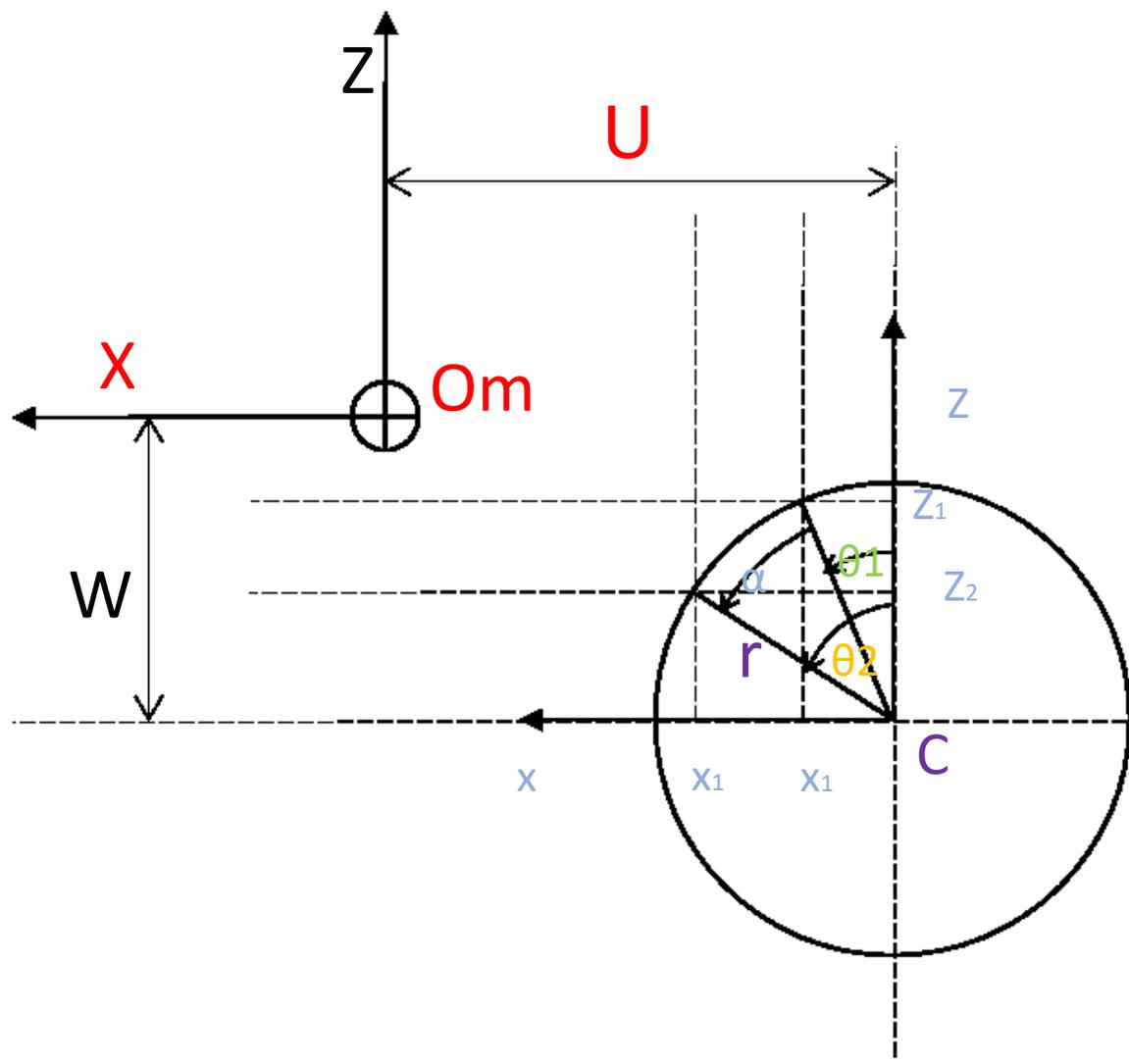
On pose:  $U$  = distance entre l'origine machine  $O_m$  et le centre de la palette suivant l'axe  $X$
